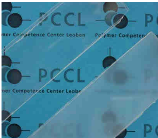
Abb. 1: Thermotrope Schicht in verschiedenen Schaltzuständen (links). Hemisphärische Transmissionen unterschiedlicher thermotroper Schichten bei einer Wellenlänge von 600 nm (rechts).
