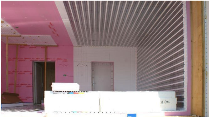
Abbildung 4 zeigt die Innenansicht der Test- und Prüfboxen für Fassaden und Fassadenelemente in der Bauphase. In der rechten Bildhälfte kann sowohl der Wandaufbau als auch die innere hydraulische Kompensationsebene eingesehen werden (Bildquelle AEE INTEC).
