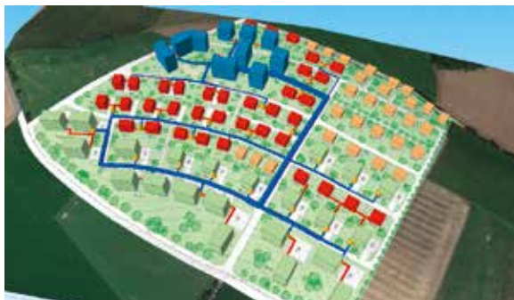
Verteilerrohrnetz eines Modellquartiers mit Mehrfamilien-Wohngebäuden mit öffentlicher Nutzung (blau), Mehrfamilienhäusern (grün), Doppelhäusern (rot) und Einfamilienhäusern (orange). Blaues Rohr: Verteilerrohrnetz, rote Rohre: Verteilstränge nach Energiezentrale (Sekundärseite), gelbe Punkte: Energiezentralen Quellen: AVORIS GmbH, AEE INTEC, google maps, data.gv.at- Open Data Österreich
