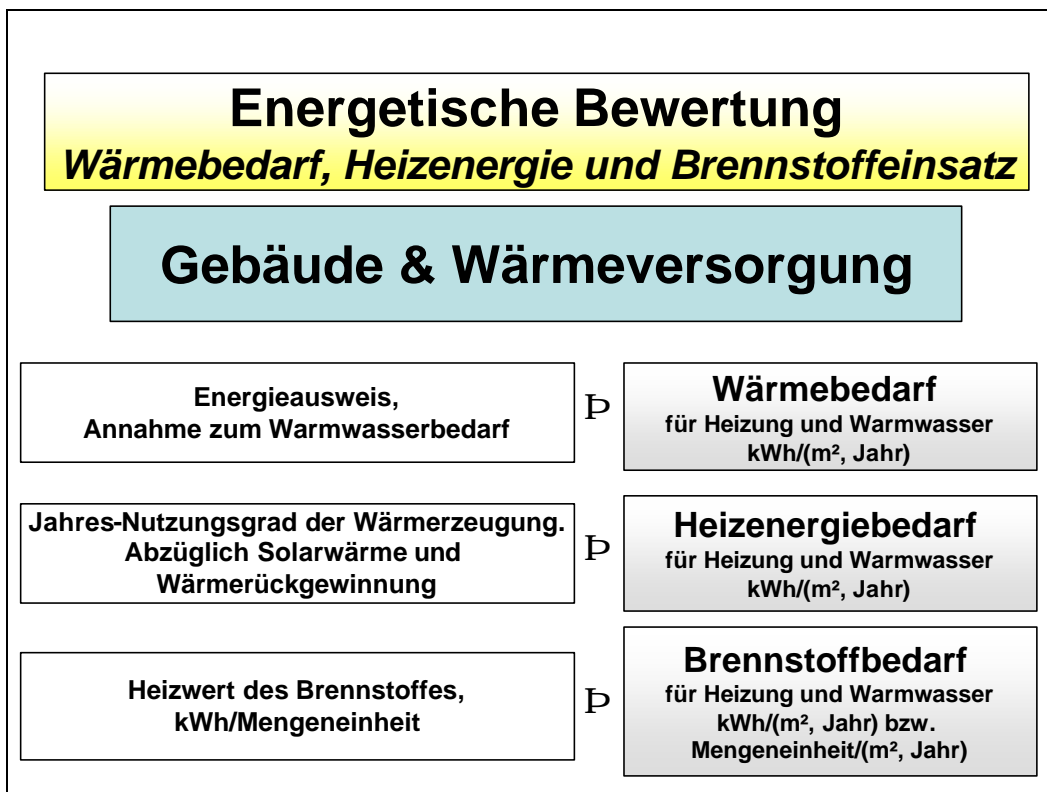
Abb. 2.2: Energetische Bewertung der Wärmeversorgung
