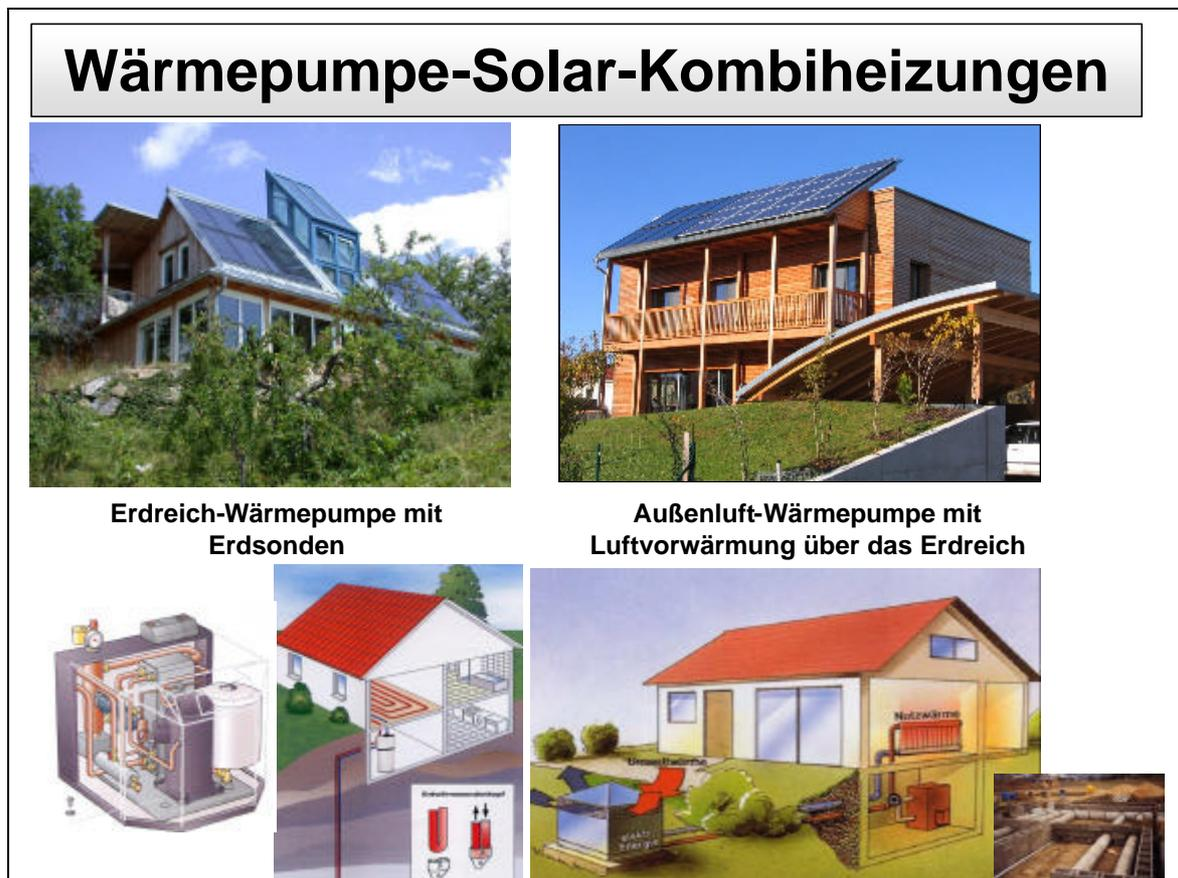
**Abb. 2a: Wärmepumpe-Solar-Kombisysteme mit Erdreich- und Außenluft-Wärmepumpe**
