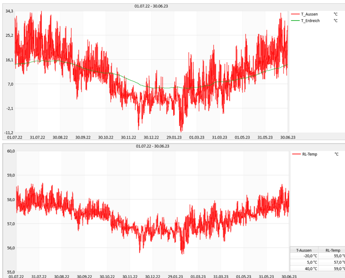
Abbildung 24: Verlauf der Außen- und Erdreichtemperatur sowie der Abnehmer-Rücklauftemperatur über den Simulationszeitraum (Pink GmbH)
