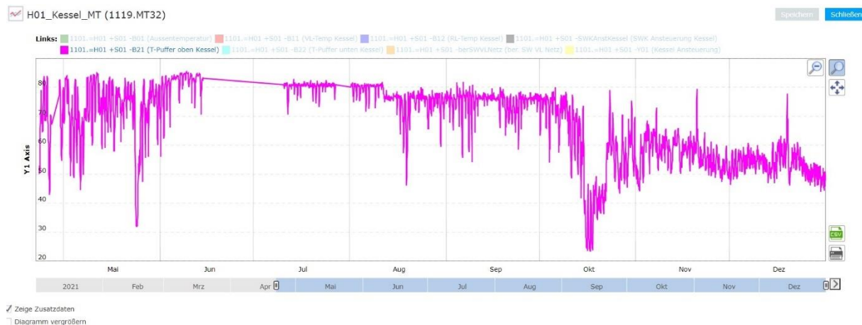
Abbildung 16: Temperaturkurve des Wärmerückgewinnung-Pufferspeichers (5000 Liter) bei Pankl Standort Ost 4 (Q: Pankl Racing)
