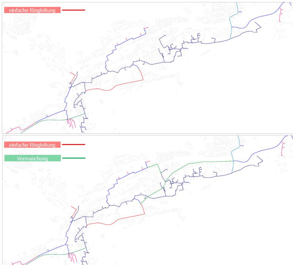
Abbildung 32: Integration einer einfachen Ringleitung sowie eine Vermaschung – „Szenario I“ (Pink GmbH)
