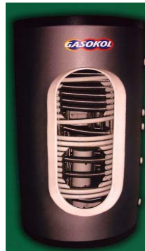
Abbildung 9: Zusätzlich zum innenliegenden Glatrohrwärmetauscher ist ein Edelstahlwellrohr zur Brauchwassererwärmung integriert
