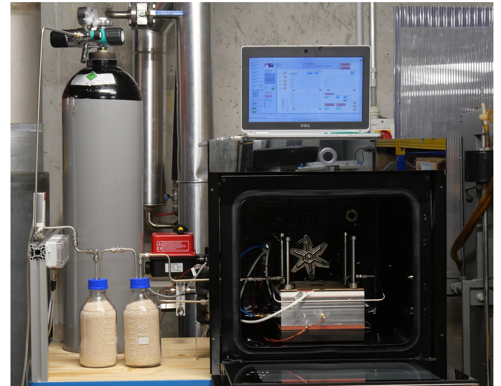
Abb.: Bild des Diffusionstest-Setups (Quelle: HSLU)
