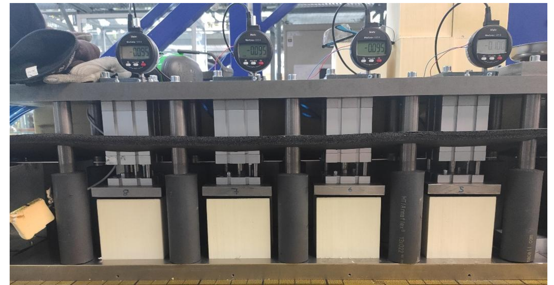
Abb...: Bild eines Teils des Creep-Setups (Quelle: HSLU)
